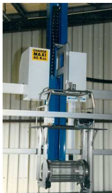
Robot URD 20 avec système de rotation
