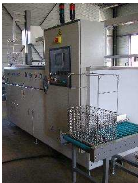
Machine U2HF60 avec robot et convoyeurs de chargement et déchargement
