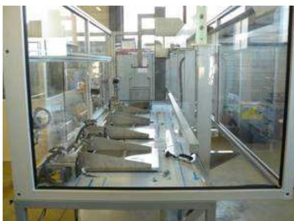
Machine U3M30 avec robot et poste unique de chargement et déchargement
